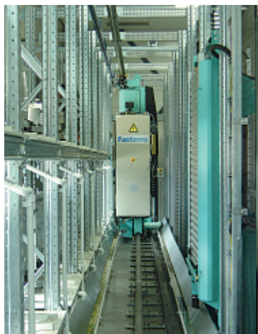
■ Het Fastems-transportstelsel haalt en brengt de pallets uit het magazijn (foto's: Erik Steenkist).
