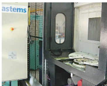
■ Palletwisselplaats aan het OKK horizontale bewerkingscentrum
