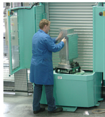
■ Laadstation waar de werkstukken worden opgespannen en weer worden afgebouwd
