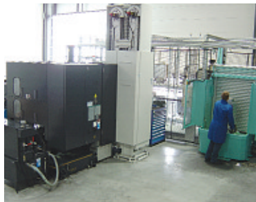
■ Overzicht laadstation, palletmagazijn en OKK-bewerkingscentrum
