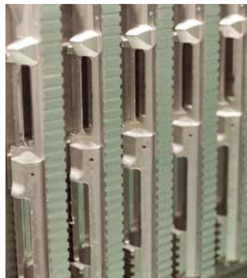
Aluminium verlengstukken worden in zeven opspanningen gefreesd, geboord en getapt o.a. op twee OKK-bewerkingscentra.
