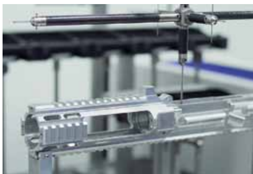
De productie van 25.000 aluminium verlengstukken wordt tweemaal daags op 870 meetpunten gemeten.
