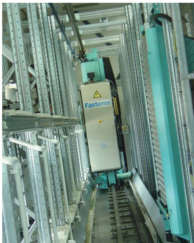
Het transportsysteem voor de geautomatiseerde productielijn bij Brandt FMI. Links het magazijn voor de pallets met opspanningen (twee verdiepingen, totaal 36 plaatsen), rechts de toegang tot het laadstation en (vooraan, buiten beeld) het bewerkingscentrum. Foto: Erik Steenkist
